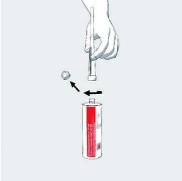
Kartusche senkrecht mit der Spitze nach oben halten, die Verschlussklappe abschrauben und den beigefügten Mischer festschrauben.
