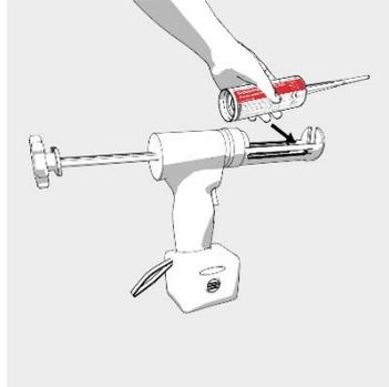
Kartusche in das vorgesehene Auspressgerät einlegen.
