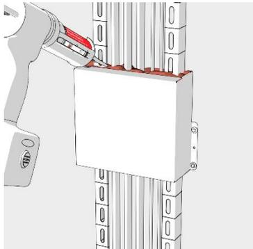
**ZZ**<sup>®</sup> 630 Brandschutzbox von oben mit **ZZ**<sup>®</sup> 330 Brandschutzschaum verfüllen. Das Schalungsband kann nach Aushärten des Brandschutzschaums entfernt werden.
