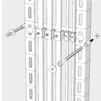
Gewindestifte mit geeigneten Befestigungsmitteln befestigen.
