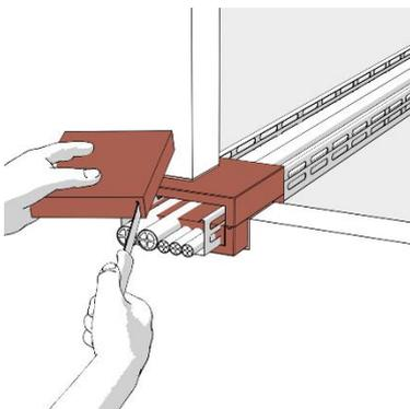
Einlage entsprechend den durchgeführten Installationen zuschneiden.
