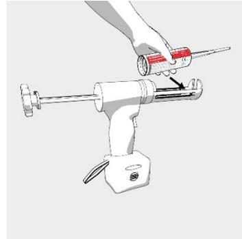
Kartusche in das vorgesehene Auspressgerät einlegen.
