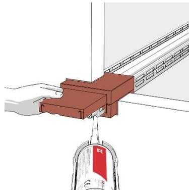
Einlage strammsitzend in die Bauteilöffnung einsetzen. **ZZ**<sup>®</sup> 300 oder **ZZ**<sup>®</sup> 333 Brandschutzmasse zur Verfüllung von Kabelzwischenräumen, Zwickel und offene Fugen mit beidseitig mindestens 20 mm Verfülltiefe.
